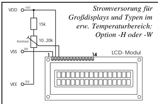
Da der Kontrast temperaturabhängig ist, sollte die Spannung an VEE unbedingt einstellbar sein (per Trimmer, Potentiometer oder Analogausgang eines  $\mu P/\mu C$ ). Wenn der komplette Temperaturbereich ausgenutzt werden soll, ist vor allem bei Hochtemperaturdisplays eine externe Temperaturkompensation sinnvoll.
